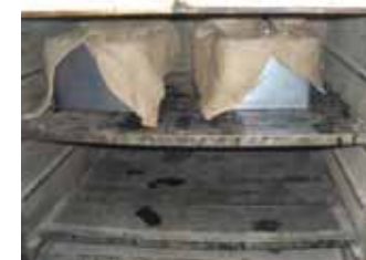
写真-解4.4 防火用シートで覆い静置 写真-解4.5 静置後に上部混合物を6kg除去
